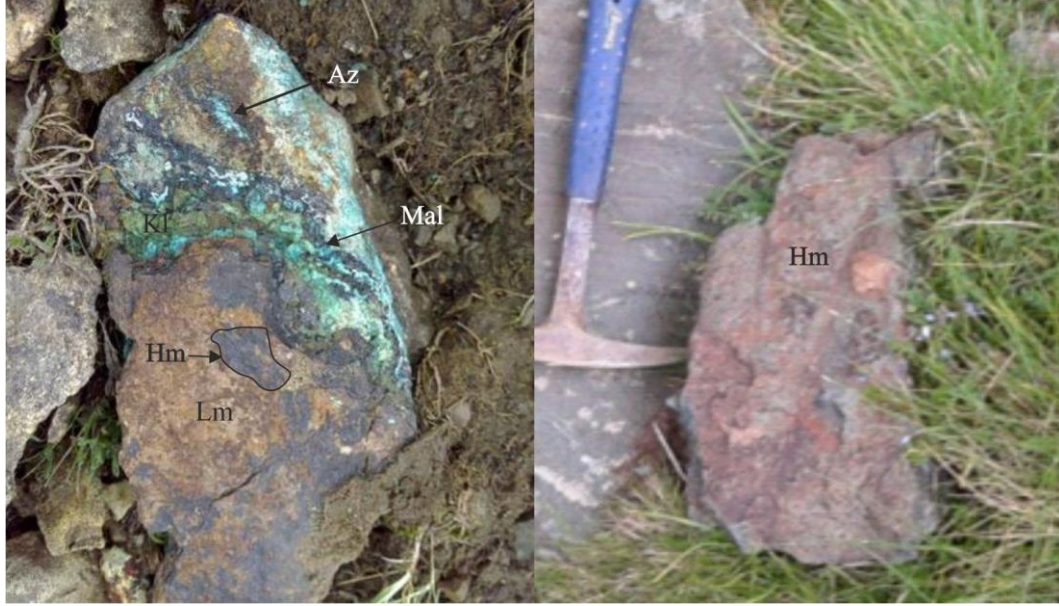
Şekil 3.23. Oksidasyon zonunda görülen ikincil cevher minerallerinin arazideki görünümü. Mlc: Malakit, Az: Azurit, Hm: Hematit, Lm: Limonit, Kl: Klorit
