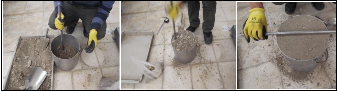
Şekil 2.6. Sıkışık birim ağırlık tayini deneyinde gerçekleştirilen işlemler
