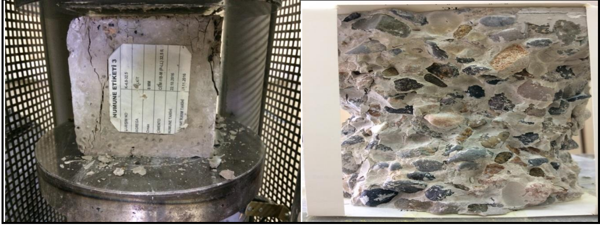
Şekil 2.10. Beton basınç dayanımı tayini için gerçekleştirilen işlemler
