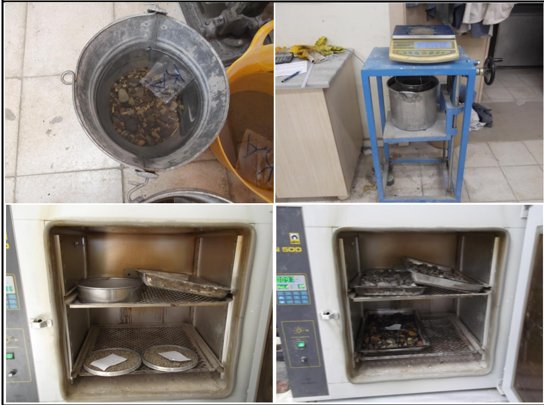
Şekil 2.5. Özgül ağırlık ve su emme oranı tayini deneyinde gerçekleştirilen işlemler
