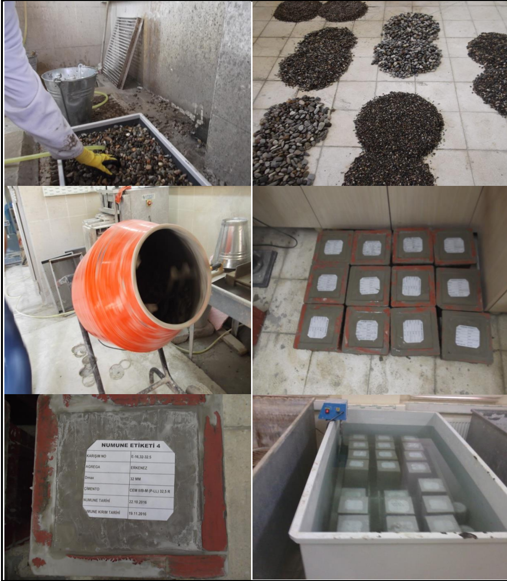
Şekil 2.7. Beton numunelerin hazırlanması ile ilgili işlemler
