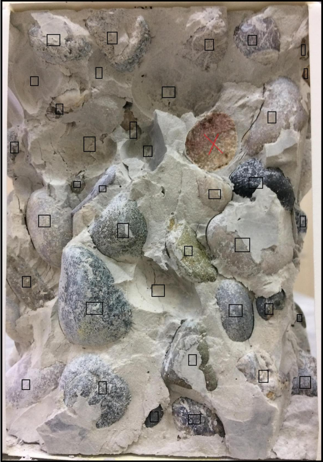
Şekil 2.14. Tane sınıfı 16/32 mm olan agregalarla üretilmiş beton numunesine ait kırılma şekillerinin işaretlenmiş olduğu görüntü
