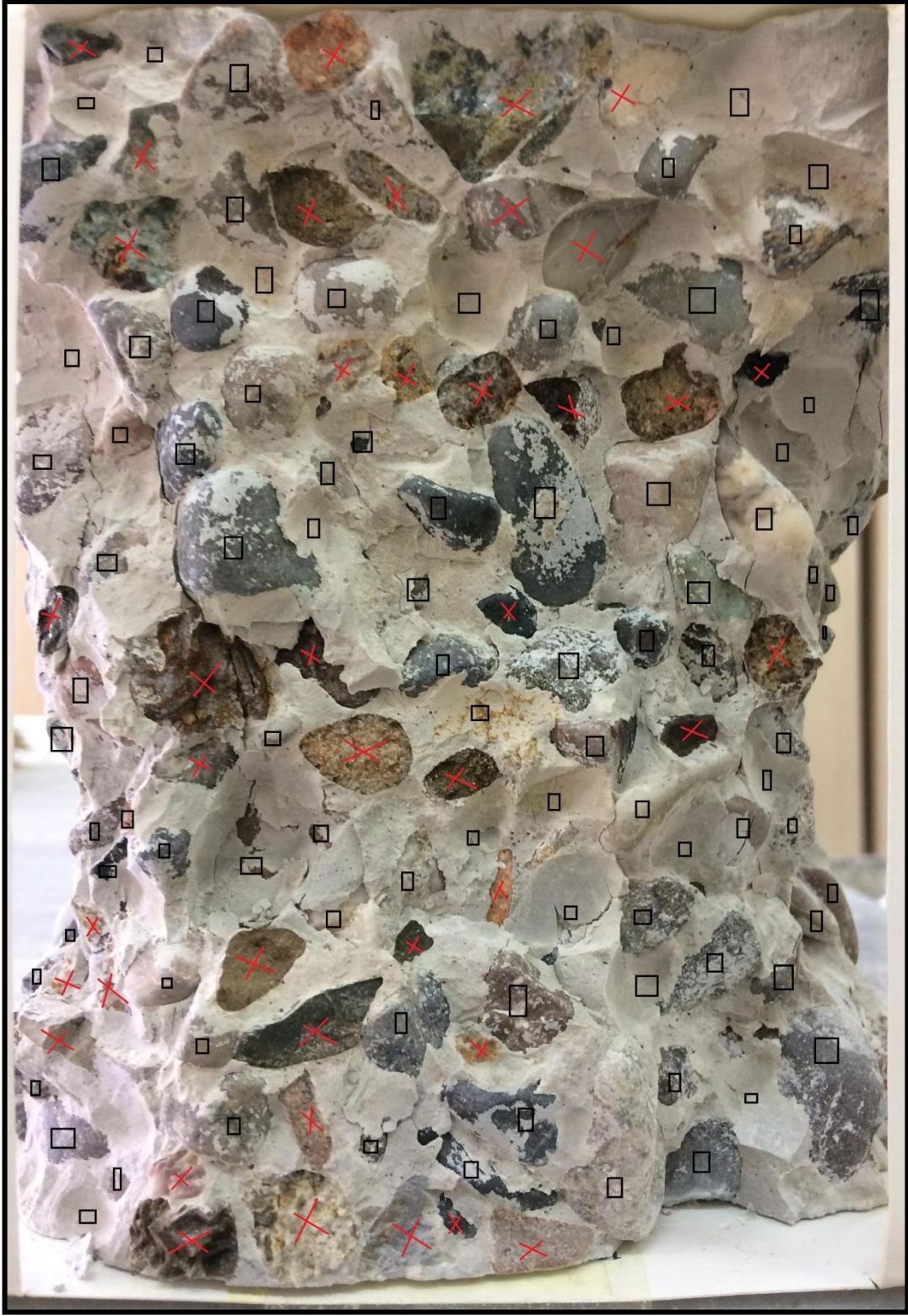
Şekil 2.13. Tane sınıfı 8/16 mm olan agregalarla üretilmiş beton numunesine ait kırılma şekillerinin işaretlenmiş olduğu görüntü
