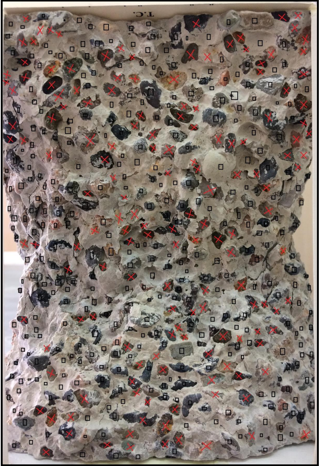
Şekil 2.12. Tane sınıfı 4/8 mm olan agregalarla üretilmiş beton numunesine ait kırılma şekillerinin işaretlenmiş olduğu görüntü
