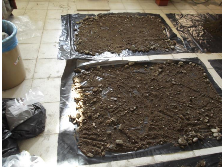
Şekil 2.4. Deney numunelerinin doymun kuru yüzey durumuna getirilmesi
