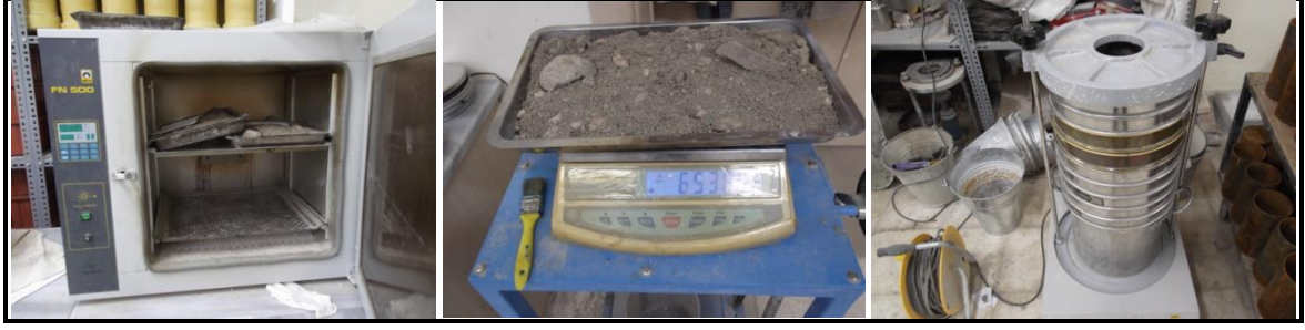
Şekil 2.3. Tane büyüklüğü dağılımı tayini deneyinde gerçekleştirilen işlemler
