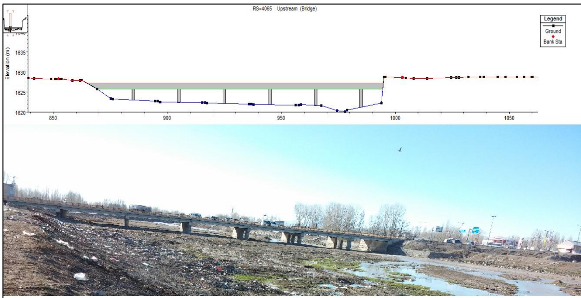
Şekil 3.3. Murat Köprüsü'nün HEC-RAS yazılımında modellenmesi ve görüntüsü
