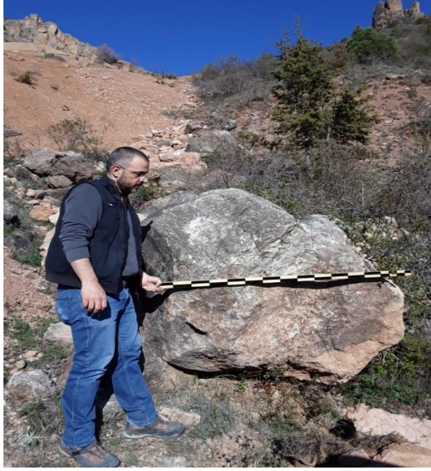
Şekil 3.2. Düşmüş kaya bloklarının şekil ve boyutlarının belirlenmesi
