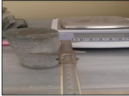
Şekil 3.20. Kompaş yöntemi ile örnek hacminin belirlenmesi
