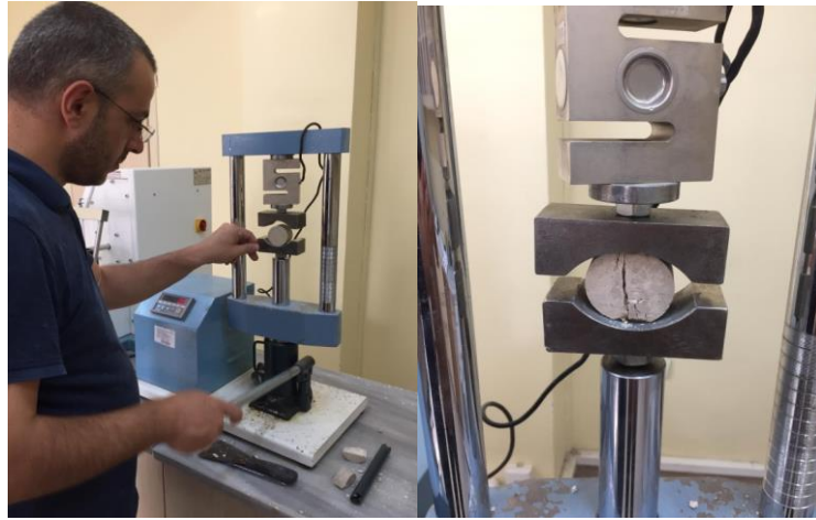
Şekil 3.21. Çekilme dayanımı deneyi (Brazilian Yöntemi)
