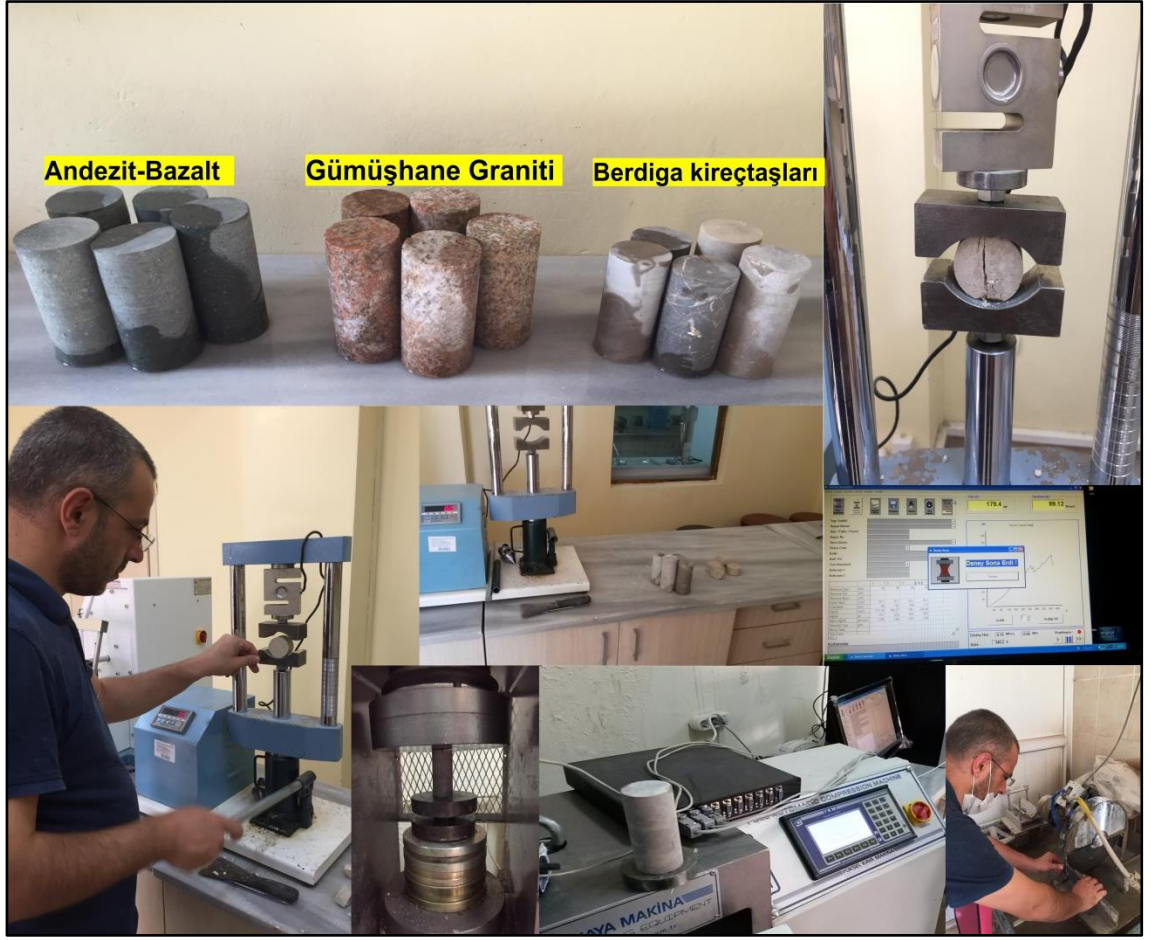
Şekil 3.3. Birimlere ait örnekler ve laboratuvar deneyleri
